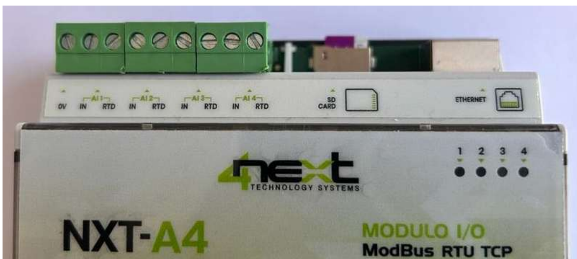
Fig. 1/A Parte superiore e morsetti del NXT-A4
