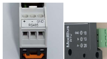
Fig. 2 Connettore RS485 EasylogXL ( Sinistra ) EasyLogXL-A ( Destra )
