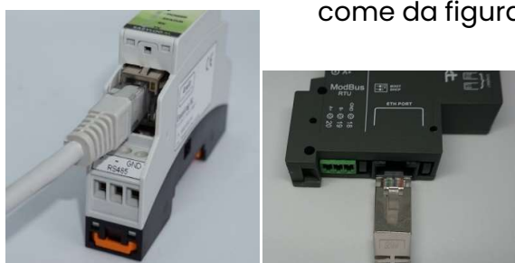
Fig. 3 Connettore Ethernet EasylogXL ( Sinistra ) EasyLogXL-A ( Destra )
