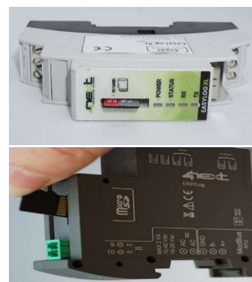
Fig. 1 Inserimento SD Card EasylogXL ( Sopra ) EasyLogXL-A ( Sotto )
