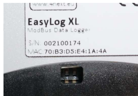
Fig. 6 Esempio posizione DIP: OFF OFF
